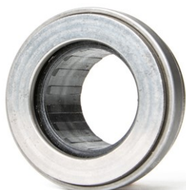
Figur 2: Udrykkerlejer med plastbøsninger SKAL IKKE påføres smøremiddel
