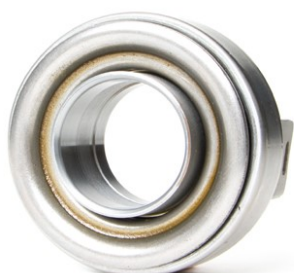
Figur 1: Udrykkerlejer med metalbøsninger SKAL påføres smøremiddel
